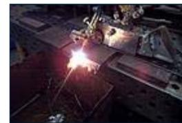
Anarbeitung von ca. 7to autogenen Brennzuschnitten t=60mm für die Verankerung von Stahlrossen an der Stahlbaukonstruktion eines Flughafengebäudes: CNC-Fräsen ("Helix zirkular") eines Einlauftrichters Ø80/Ø52, auf der Gegenseite eine Anspiegung ("Kreistasche") Ø126x4mm zur Fixierung der Unterlegscheibe zur Verspannung des Stahlseiles
