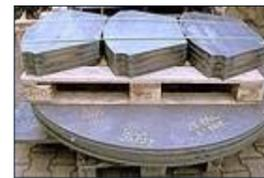
Baggerzähne ("Schalenspitzen") aus 1.8734 (verschleißfestes Material Hardox/XAR 500) vorgewärmt, Kontur auf Maschine gebrannt, zusätzliche Schrägen per Hand vorgeschritten, gestrahlt, vor der weiteren mechanische Bearbeitung.
