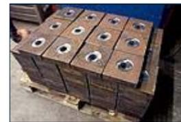
Autogene Brennzuschnitte S355J0 St52-3 n. DIN EN ISO 9013/1113 ca. 770x510x220mm, Normaleben nach EN 10029, Oberfläche gemäß EN 10163, spannungsarm geglüht, Dicke gestrahlt SA 2 1/2
