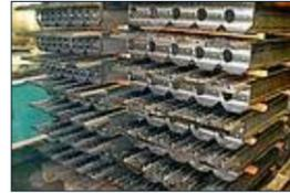
Schweißkörper St37 ( Serienteil) ca. 600x250x150mm für Positionierachsen, geschweißt, gegläht, gestrahlt, in 2 Aufspannungen von 4 Seiten mechanisch bearbeitet.
