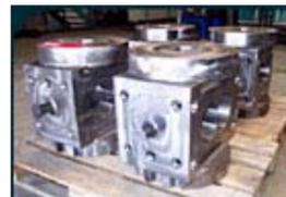
Gabelköpfe aus Gussteilen GS-20Mn5QT+ (1.6220) für Offshore, Parkhäuser, Stahlbau, Brücken etc. Gewindegrößen M76, M85, M95 links und rechts gefräst, Passung für Bolzen gespindelt
