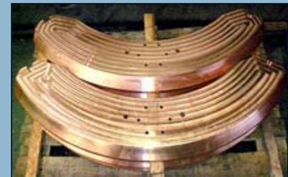
Kupferplatten ca. 1500x400x60mm aus SE-CU (Werkstoff 2.0070) nach dem CNC-Fräsen und Tieflochbohren
