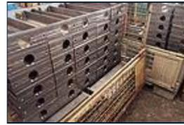
Berstgestänge für grabenlose Rohrverlegung 2000 x Ø100, im Tiefbau ; Vergütungsstahl ca. 900 N/qmm
