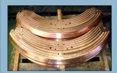
Kupferplatten ca. 1500x400x60mm aus SE-CU (vverkstoff 2.0070) nach dem CNC-Fräsen und Tieflochbohren
