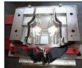
Teile für Druckgießwerkzeug aus 1.2343, nitriert, Einsatzteil Rahmen
