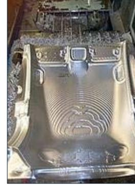
Formplatte Düsenseite 1.2085 ( X33CrS16) aus gesägtem Vormaterialblock ca. 850x850x180mm : Außenkontur fräsen, Konturen und Taschen einfräsen und schlichten, Tiefbohren d=12mm, diverse Schrägbohrungen und -passungen 25H7
