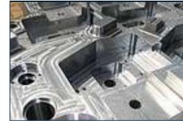
Formrahmen Düsenseite für Mittelkonsole eines PKW aus 1.2312 40CrMnMoS8-6) Ca. 1200x700x200mm incl. Heißkanaltaschen und Tieflochbohrungen Vorgefräst für die HSC Finishbearbeitung mit Offset 0,7mm
