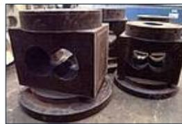
Spannungsarmglühen von Kernkästen St52 für den Werkzeugbau
