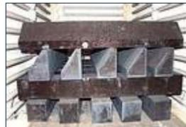
Zwischenglühen von P-Platten für den Formenbau aus 1.2312 nach dem Vorfräsen
