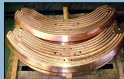
Kupferplatten ca. 1500x400x60mm aus SE-CU (Werkstoff 2.0070) nach dem CNC-Fräsen und Tieflochbohren
