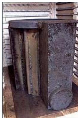
Normalglühen vorgeschruppter Führungsleisten aus 20MnCr5 vor dem Fertigfräsen
