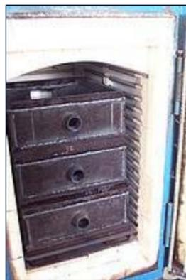
Spannungsarm Glühen eines Gehäuses St52 für einen Ziehkissenzylinder an einer Hydraulikpresse
