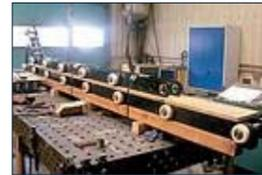
Rollenböcke St52 geschweißt, mechanisch bearbeitet, lackiert, Laufrolle aus GG40 gedreht und montiert, als paarige Führungselemente für die Wasserhaltung von Schifffahrtsschleusen
