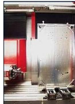
Tieflochbohren von Spannhydraulik, Kühlschmierstoffzuführung und Temperierkreisläufen an einem 2m- Vorsatzspindelkopf für Portalfräsmaschine; Guss GJS-400, Bohrungen Durchmesser 8,7 - 11,7 - 16,0mm. Gemäß Forderung des Herstellers wird ausschließlich trocken, also ohne Tiefbohröl oder Emulsion, sondern ausschließlich mit Luft gebohrt!
