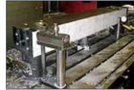
Tiefbohren von Drehfedern für den Motorsport aus 1.2709 (X3NiCoMoTi18-9-8 ; hochfester, zäher, martensit-aushärtbarer Stahl mit Arbeitshärte 56HRC) im Durchmesser 14,5mm und einer Oberflächengüte von <math>Rz=10</math> nach Finalbearbeitung (zur Vermeidung von Rißgefahr)
