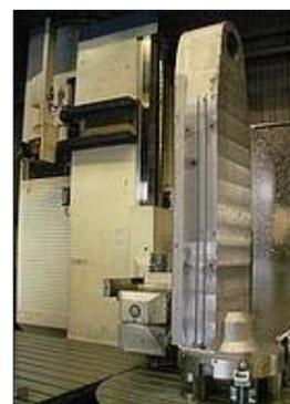
Tieflochbohrung Ø 40mm an Hydraulikverteiler ca. 500x120x70 mm aus Aluminium ALMg4,5Mn
